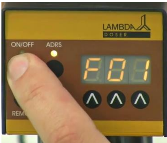
Figura 2-3: Presione el botón ON/OFF . La señal "F01" aparecerá brevemente en la pantalla, esto indica que ya se puede introducir el primer valor de caudal.
