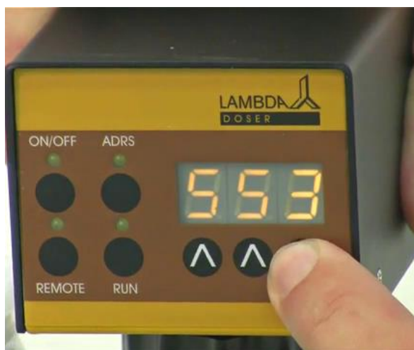
Figura 1-13: Elección de la velocidad de adición de sólido en polvo con ayuda de los botones de flechas ^ ^ ^ .
