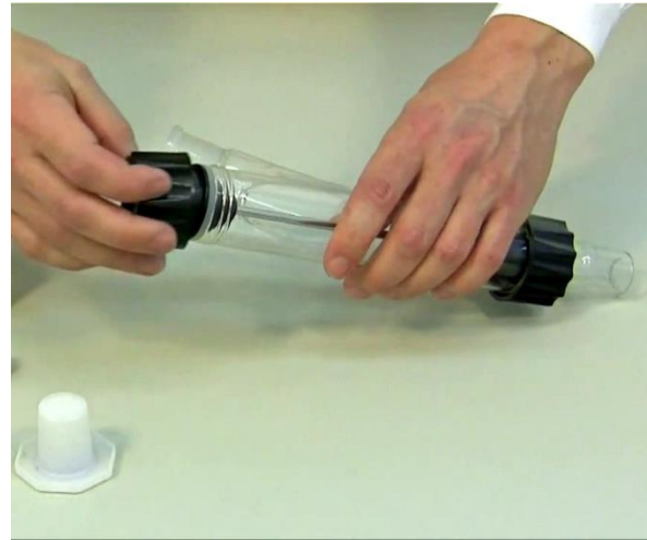
Figura 1-8: Asegure la pieza centradora del eje distribuidor, pasándola a través del eje y con la tapa con rosca al recipiente de vidrio con brazo lateral.
