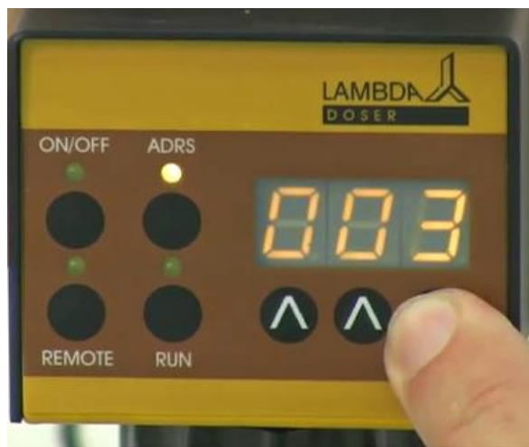
Figura 2-6: Seleccione el periodo de tiempo deseado para el para el primer paso del programa presionando los botones de flechas debajo de la pantalla ▲▲ (desde 0 hasta 999 minutos o 00.0 hasta 99.9 minutos). Presionando el botón ADRS , el tiempo de resolución puede ser ajustado en 0.1 minutos. En el tiempo de resolución de 0.1 minuto se muestra un punto entre los dígitos. ej. "00.1".
