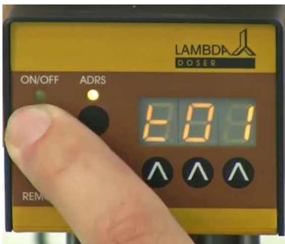
Figura 2-5: Pulse nuevamente el botón ON/OFF . La señal "t01" aparecerá por unos breves segundos en el la pantalla, lo que indica que ya se puede programar el tiempo en minutos del primer paso o en pasos de 0.1 minutos.
