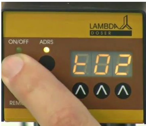
Figura 2-9: Presione nuevamente el botón ON/OFF . Aparecerá brevemente el mensaje "t02" en la pantalla.
