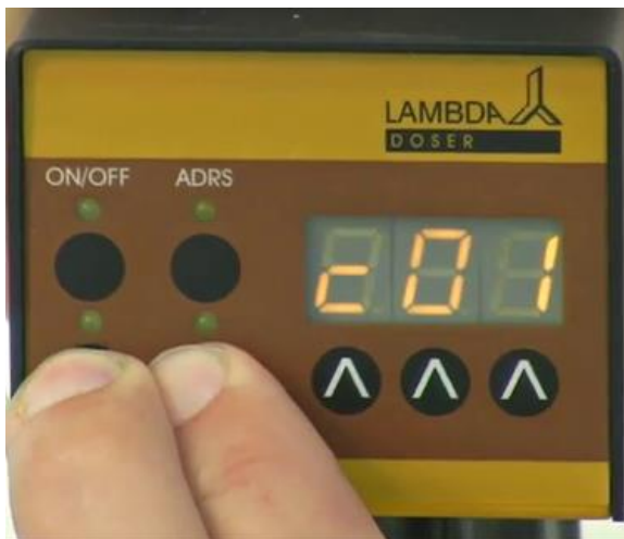
Figura 2-13: Presione simultáneamente los botones REMOTE y RUN y verá la indicación "c01" en la pantalla. Esto indica que el programa será ejecutado solo una vez y el dosificador de polvos se detendrá después.
