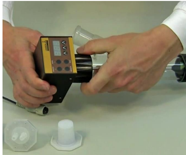
Figura 1-10: Presione el eje de la unidad del motor hacia dentro de la pieza centradora del eje distribuidor completamente. De esta forma el saliente de metal de la unidad del motor encajará en una de las hendiduras de la pieza mencionada. Esto asegura un sellado perfecto y presión suficiente del distribuidor contra el disco de Teflón en el fondo del recipiente de vidrio con brazo lateral del DOSER.
