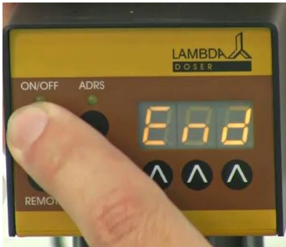
Figura 2-15: Presione nuevamente el botón ON/OFF hasta que la indicación “ End ” aparezca en la pantalla para confirmar y salvar el programa.
