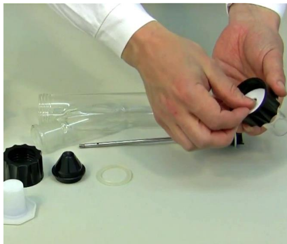
Figura 1-2: Ponga el disco de Teflón dentro de la tapa con rosca y colóquelo sobre la superficie plana del adaptador de vidrio con ajuste o boca esmerilada.
