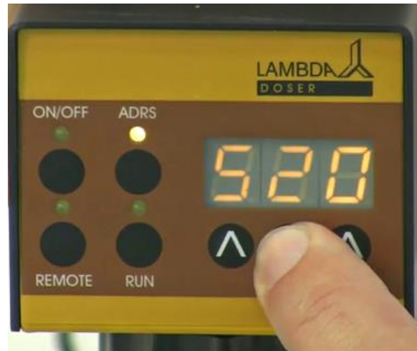
Figura 2-8: Ahora puede entrar el valor de velocidad de flujo o caudal deseado para el segundo paso.
