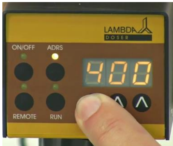
Figura 2-4: Pulse los botones debajo de la pantalla para establecer el valor de caudal deseado (entre 0 y 999, que representa entre 0 y 100% de la velocidad del motor) presionando los botones de flechas ▲▲▲ debajo de la pantalla.
