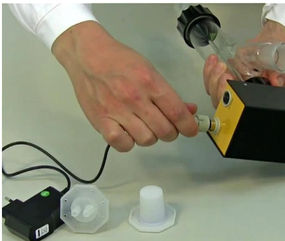
Figura 1-11: El conector de 12 V de la fuente de energía se conecta en el enchufe de 12 V CD de la unidad del motor y la fuente de energía es conectada a su vez a la toma principal.
