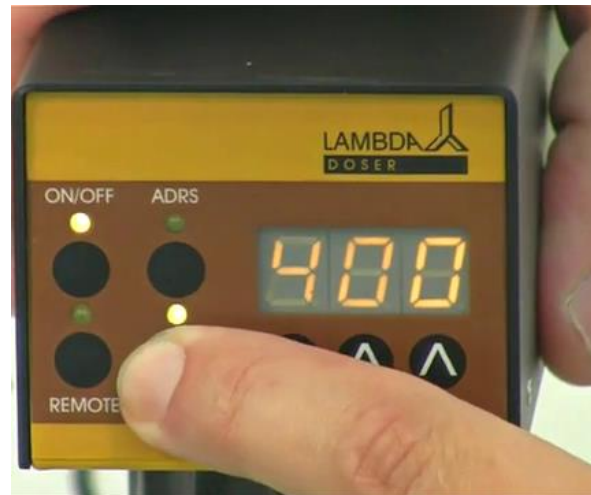
Figura 2-16: Para comenzar el programa presione el botón RUN . En este momento estarán encendidos los LED de los botones RUN y ON/OFF .
