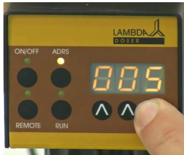
Figura 2-10: Ahora puede entrar el valor de tiempo deseado para el segundo paso.
