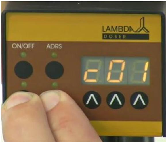
**Abb. 27:** Die **REMOTE** und **RUN** Tasten werden gleichzeitig gedrückt. Auf der Anzeige erscheint **“c01”**. Das heisst, dass das Programm nur einmal durchgeführt wird. Danach stoppt der DOSER.
