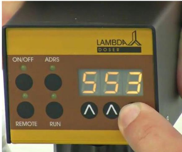
**Abb. 13:** Die Pulver-Zugabegeschwindigkeit wird mit Hilfe der drei Digital-Stellknöpfe  $\wedge \wedge \wedge$  eingestellt.
