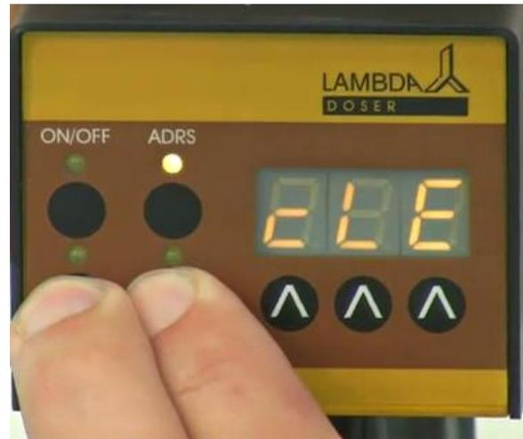
**Abb. 16:** Kontinuierliches gleichzeitiges Drücken der REMOTE und der RUN Tasten (nachdem „PGM“ bereits auf der Anzeige erschienen ist) führt zur Anzeige „CLE“: Das zuletzt gespeicherte Programm wurde gelöscht
