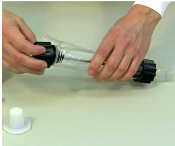
**Abb. 8:** Das Zentrierteil wird auf der Verteilerachse gesichert, indem die Schraubkappe auf den Glastubus verschraubt wird.
