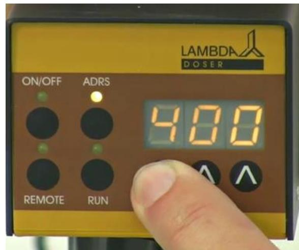
**Abb. 18:** Der Wert der Zugabegeschwindigkeit für den ersten Programmschritt wird über die drei Tasten **▲▲▲** unterhalb der Anzeige eingegeben. (Die Werte zwischen 000 und 999 entsprechen 0 bis 100% der maximalen Rotorgeschwindigkeit.)
