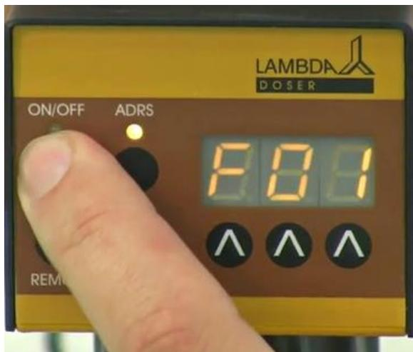
**Abb. 17:** Die ON/OFF Taste wird gedrückt. „F01“ erscheint kurz auf der Anzeige. Der DOSER zeigt damit an, dass die Zugabegeschwindigkeit (Förderrate) des ersten Programmschrittes eingegeben werden kann.
