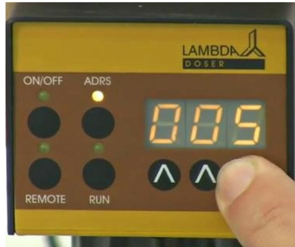
**Abb. 24:** Jetzt kann die **Dauer für den zweiten Programmschritt** über die drei Tasten **▲▲▲** eingegeben werden. Die **Zeitauflösung** (1 oder 0.1 Minute) kann wie oben beschrieben durch die **ADRS**-Taste erneute geändert werden.
