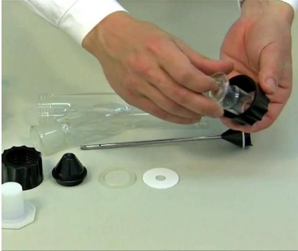
**Abb. 1:** Das Schliffteil wird durch die Schraubkappe geschoben.
