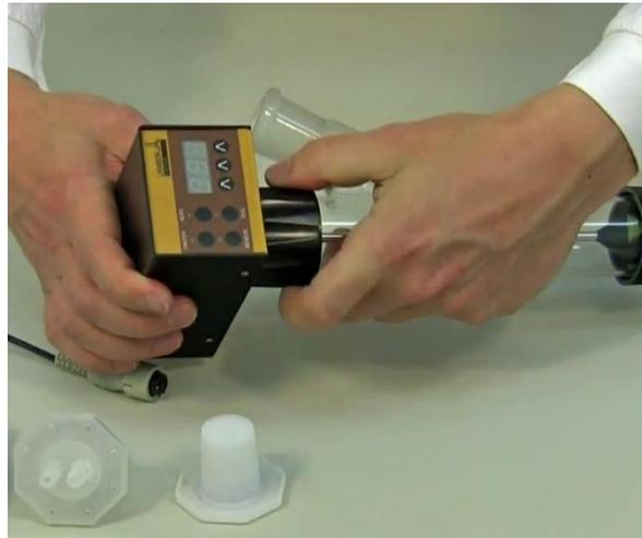
**Abb. 10:** Die Motoreinheit wird durch Druck und einer leichten Drehung bis zum Einrasten des Stifts mit der Verteilerachse gekoppelt. Das gewährt die perfekte Abdichtung des LAMBDA DOSERs und den optimalen Druck des Verteilers gegen die Teflonscheibe am Boden des Glastubus.
