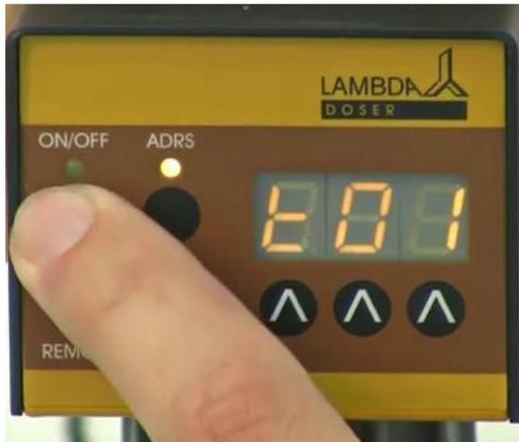
**Abb. 19:** Durch Betätigung der **ON/OFF** Taste wird der Wert gespeichert. „t01“ erscheint kurz auf der Anzeige. Der DOSER zeigt damit an, dass die Dauer (Minuten) des ersten Programmschrittes eingegeben werden kann.
